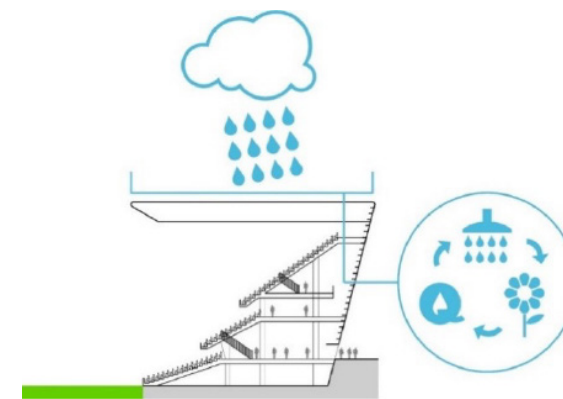
Diagramma che illustra la raccolta dell'acqua dal tetto di uno stadio
